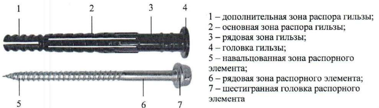
Рис. 1. Общий вид деталей анкера пластикового GRAF SDP
