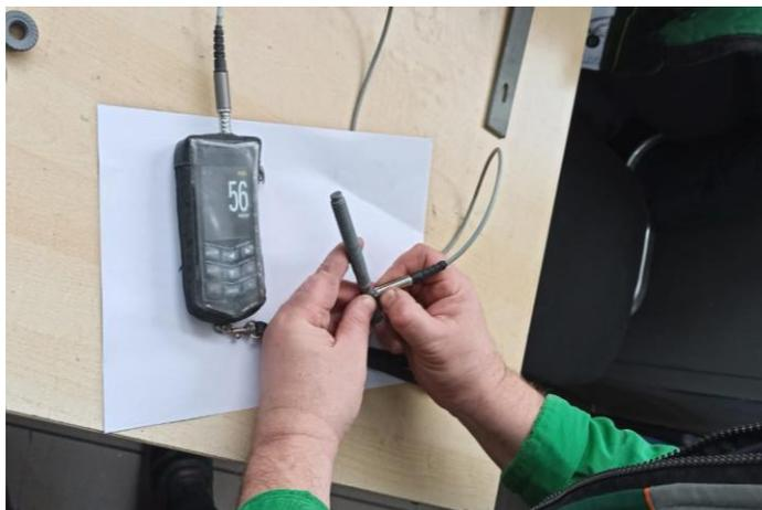
Толщина покрытия была измерена толщиномером Константа К5" (заводской номер 18282, номер свидетельства С-ГДМ/19-07-2023/263157072, дата поверки 19.07.2023 г.).
