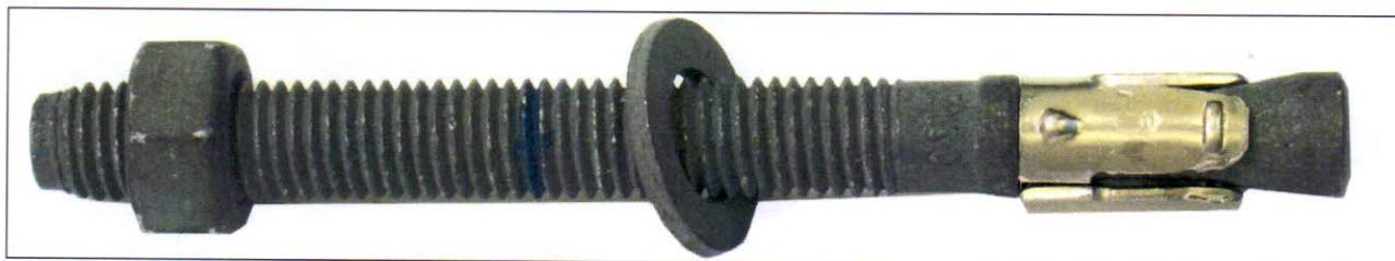
Рис. 1 Образец анкера с покрытием термодиффузионный цинк, поступившего на исследование
